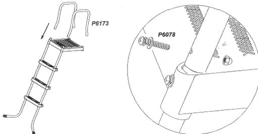
Abbildung 5 5. Montage der übrigen Stufen (Abbildung 5):
