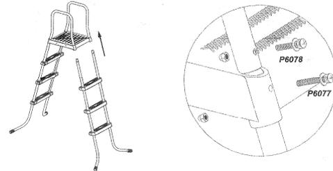
Abbildung 6 6. Ziehen Sie alle Schrauben fest. Installieren Sie P6213 (Warnschild). (Abbildung 6):
