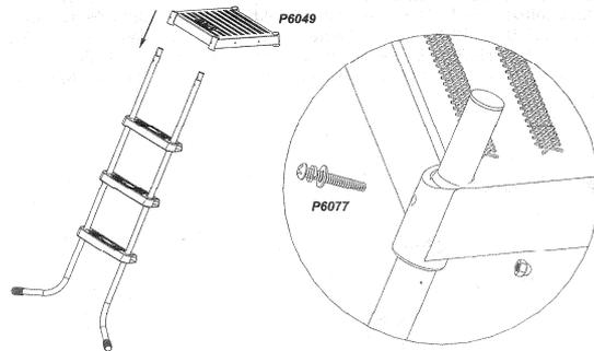
Abbildung 4 4. Montage der gebogenen Handgriffe (Abbildung 4):
